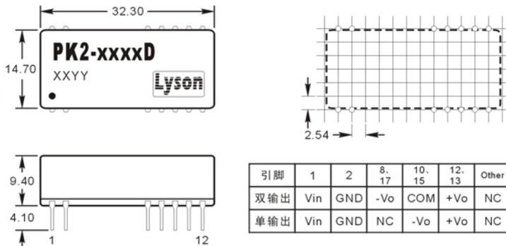
注：所有单位尺寸为mm，所有相邻端子间距2.54mm，所有端子直径0.5mm。
