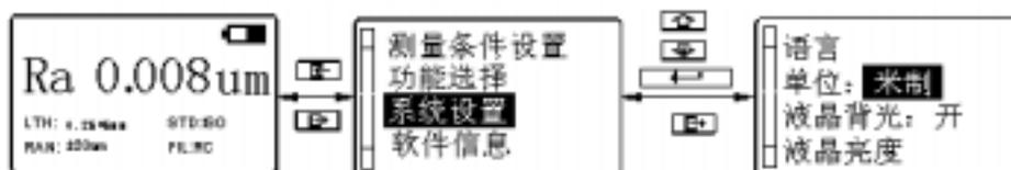
图 2-16 米制/英制转换功能
