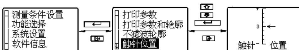
图 2-23 选取显示触针位置功能
