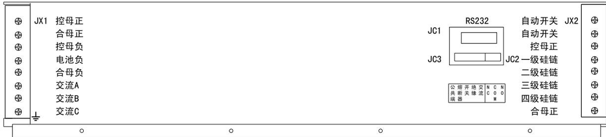
整流模块托架后背板接口示意图
