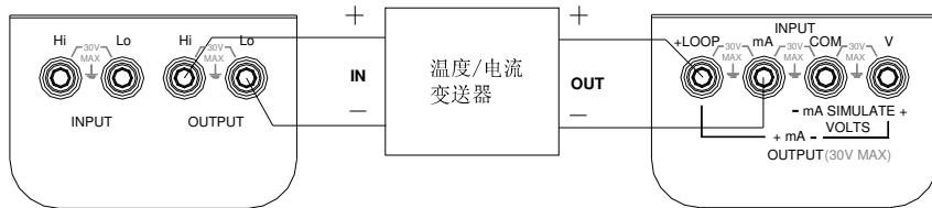
VC14 输出一个标准的温度信号给变送器的输入, VC15 给变送器提供 24V 工作电压同时测量它的输出电流, 例如 K 型 0—1000°C, 对应 4—20mA 电流输出, VC14 给出 500°C 输出时, VC15 显示 12mA.
