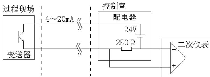
在现场的变送器由控制室提供 24V 电源,将由 TC 或 RTD 采集的信号放大并变为标准的 4—20mA 信号,送给控制室,由控制室二次仪表或 DCS 进行计算后,送出标准 4—20mA 控制信号到执行机构调节阀门进行动作.
