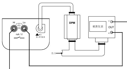
外加压力同时加到压力变送器及 DPM 上,DPM 的输出送给 VC16 显示,同时 VC16 给变送器提供 24V 电压并测输出电流,例如: 测量压力为 0—100KPa,输出 4—20mA,则 50KPa,VC16 上部显示 50KPa,下部显示 12mA 或者 50%,同时 VC16 也具有开关测量功能,可校验压力控制器.
