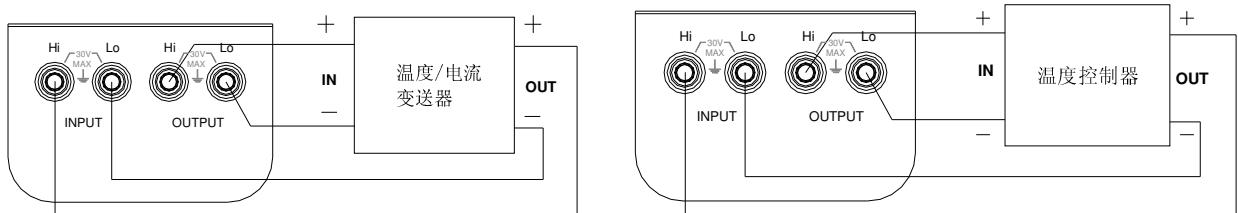
VC12 是一台可输出 mV/Ω/TC/RTD 信号和测量 V/mA 信号的校验仪. 输出与输入隔离并可同时进行操作和显示. 特别适合温度变送器的校验. 同时它具有的开关量测量能力, 特别适合校准温度控制器, 它所具有的开关动作时保持显示值的功能, 可准确地测量控制器的动作不灵敏区.
