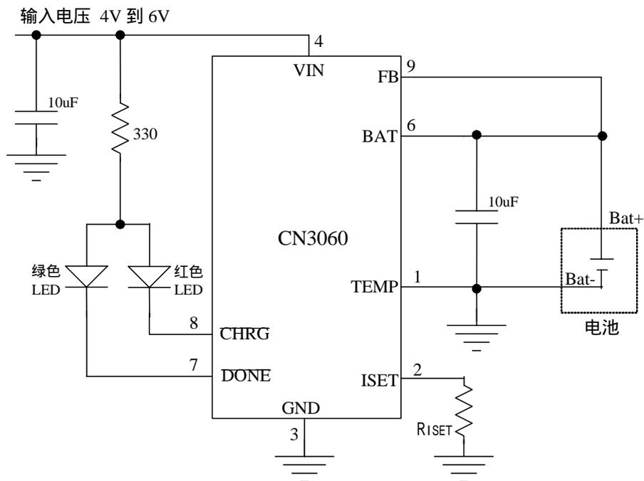
图 1 典型应用电路（恒压充电电压 3.6V）
