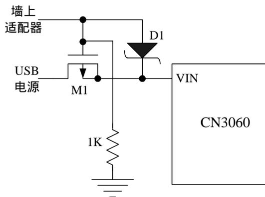
图6 同时使用墙上适配器和USB接口
