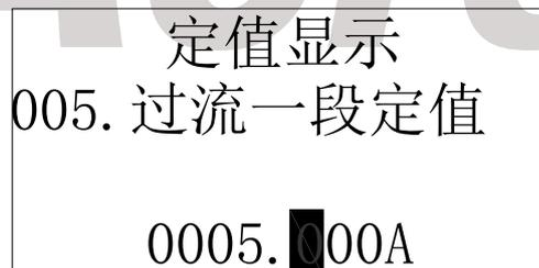
按“^”、“v”键，显示其他定值，按“<”、“>”键，移动光标，按“+”、“-”改变数值，按“确定”设置定值。当要修改多个定值一定要先改变它们的值，最后按“确定”键一起完成设置，这样可以减少 FLASH 的插除次数，提高装置使用年限。
